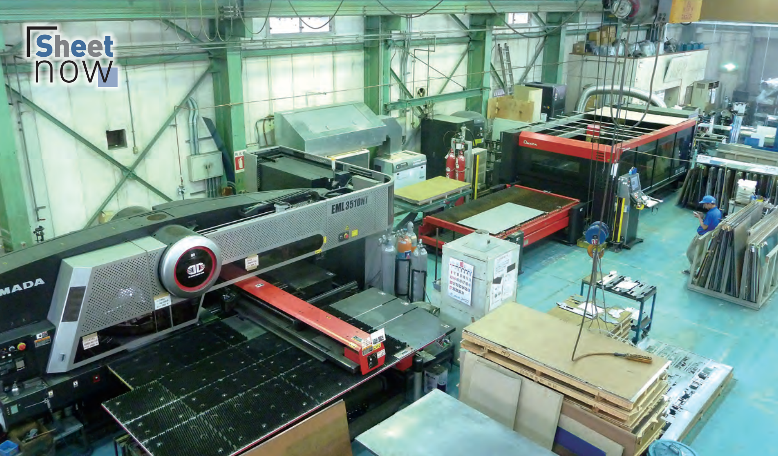
ブランク工程にはパンチ・レーザ複合マシンEML-3510NTとレーザマシンFO-MII 3015NT+LST-3015FOMIIが並ぶ
